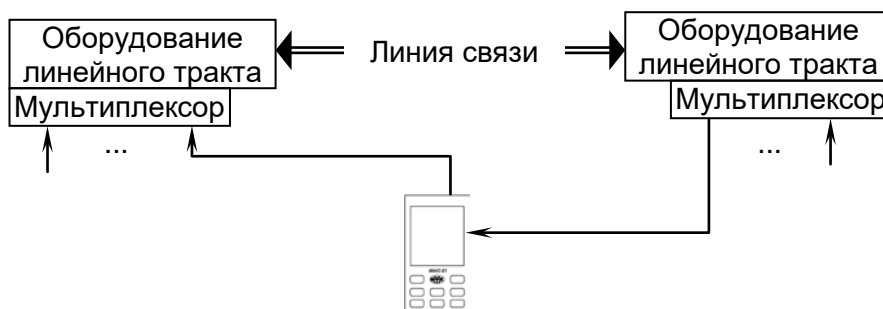
Рис. В1.1. Схема тестирования канала N×64 Кбит/с
